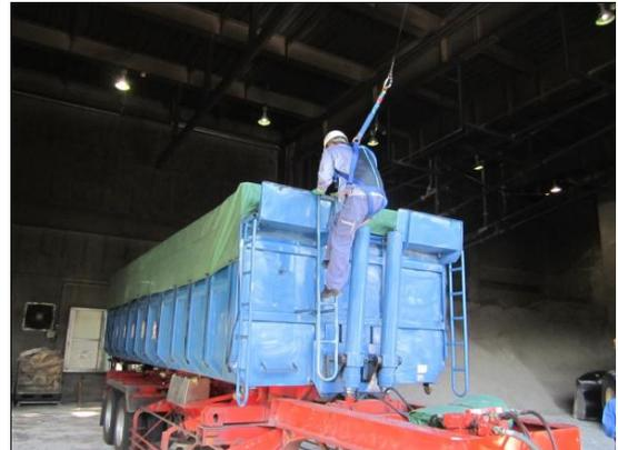
④ シート掛け作業時の安全帯取付け設備
