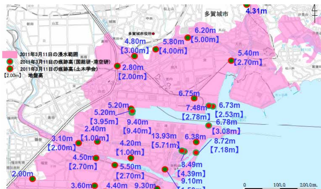
(図1) 東日本大震災における仙台塩釜港周辺の津波の浸水被害(国土交通省港湾局の資料より)
