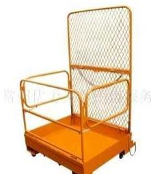
どうしてもフォークリフトを利用して高所作業を行う必要がある場合は、左図のように人を載せるための専用台を設置しなければなりません。また転落を防ぐために、柵の施錠措置や安全ベルトの配備を行うことも不可欠です。
