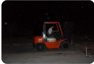
夜間荷役作業時の照度が低いと、進行方向の視界を確保できず、接触や衝突で積荷の落下が発生する恐れがあります。
