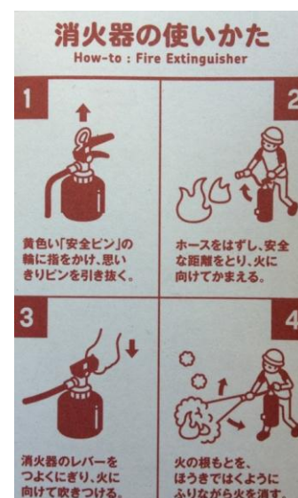
【図】消火器使用の基本ステップ
