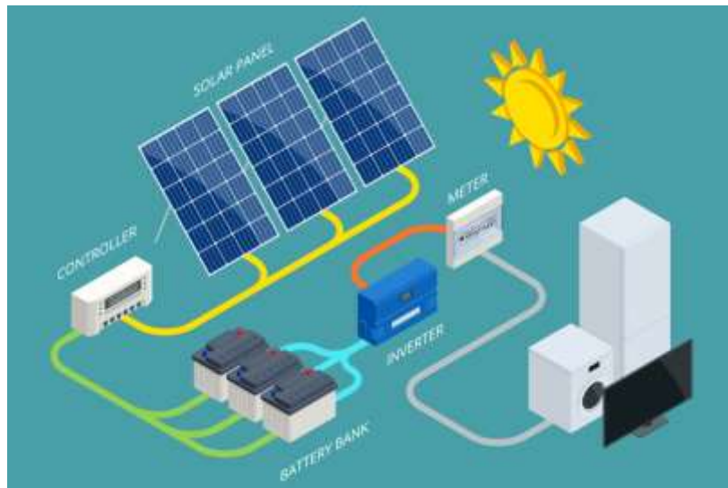
図1 太陽光設備の構成機器 (出典: istock)
