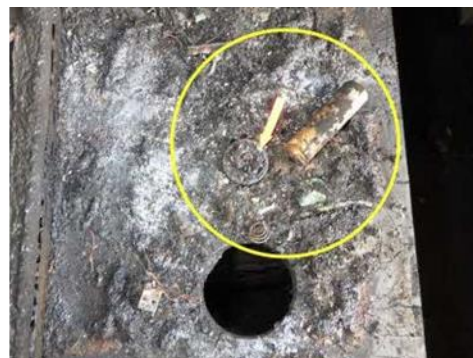
携帯型扇風機の焼損状況
