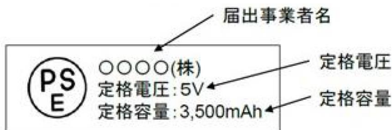
【図6】モバイルバッテリー（リチウムイオン電池）に付される表示の例 2)
