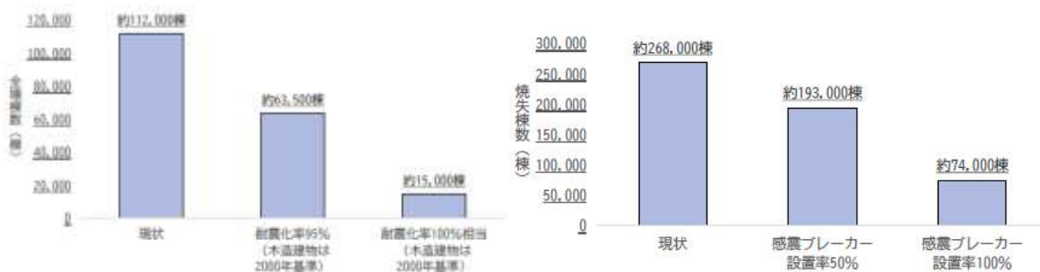
【図8】 耐震化率・感震ブレーカー設置率による建物被害低減効果 9)
