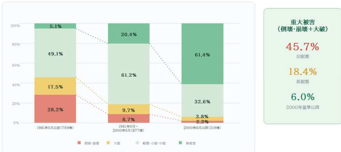
【図 1】平成 28 年熊本地震における木造の建築時期別の被害状況
