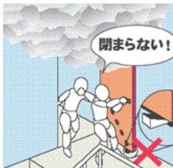
図4 常時閉鎖式防火戸が開放されている事例（出典：堺市<sup>(3)</sup>）
