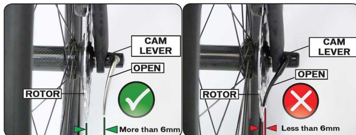
正常（間隔が 6 mm 以上） 不良（間隔が 6 mm 以下）
